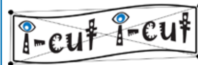
Triangoli inadeguati per immagini distorte usando solo quattro segni di registro
